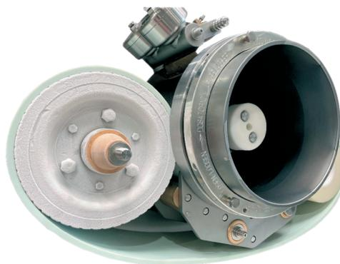
Coolmatic und Speedmatic sind interessante Optionen. Erstere minimiert die ansonsten physi-kalisch unvermeidliche Temperaturerhöhung des Produkts, mit Letzterem steuern wechselnde Produktzuflussmassen die Arbeitsdrehzahl der SEPAmatic. Somit wird Verschleiß, Erwärmung und unnötige Energieaufnahme vermieden.
